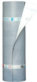
Membrane d'étanchéité autocollante composée de bitume modifié avec des polymères SBS et d'un tissu de polyéthylène trilaminaire en surface utilisée sur les murs de fondation et d'autres parois verticales enterrées.
